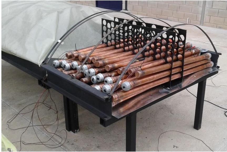
**Figura 6-1.** Fotografía de montaje de los tubos en el módulo de acumulación
