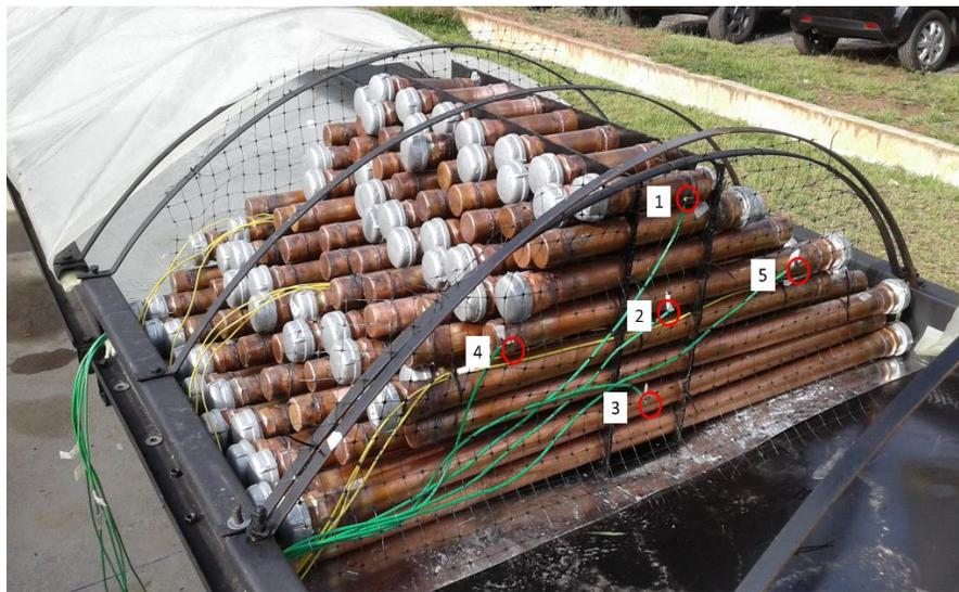
**Figura 6-2.** Fotografía de la instalación de los termopares a la entrada y a la salida del sistema de acumulación
