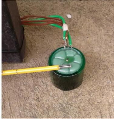
**Figura 6-7.** Calibración de termopares con un termómetro de mercurio de referencia
