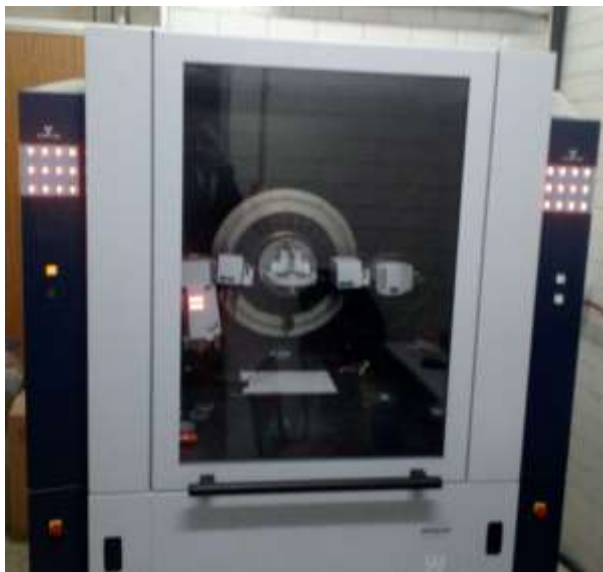
Figura 2-9. Equipo de Difracción de Rayos X D8 Advance
