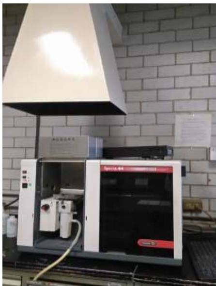
Figura 2-6. Espectrómetro de absorción atómica Varian SpectraAA 220FS
