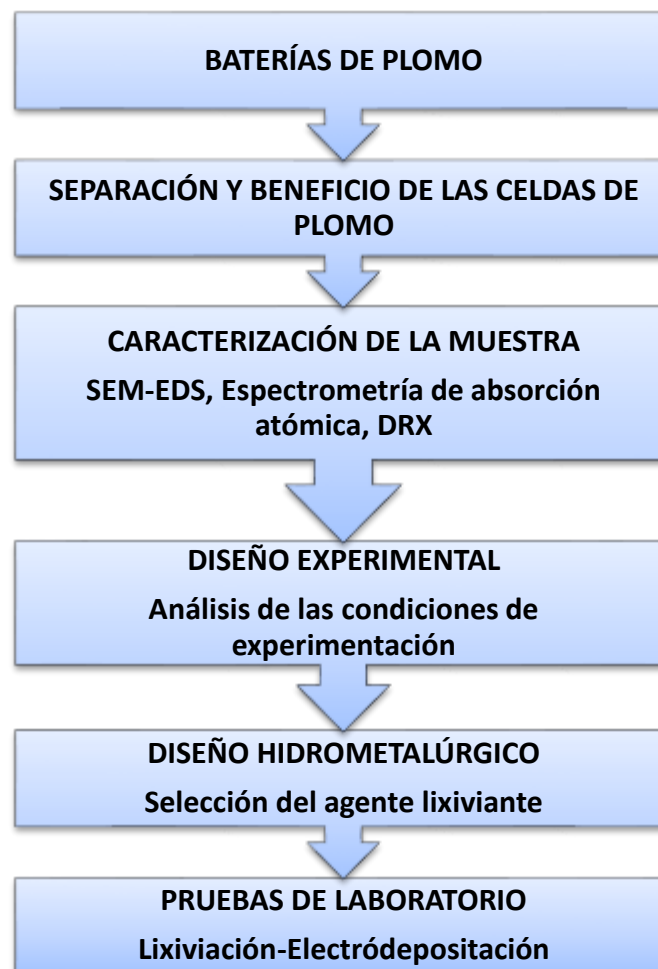
Figura 2-1. Diagrama de flujo para el proceso de reciclaje propuesto
