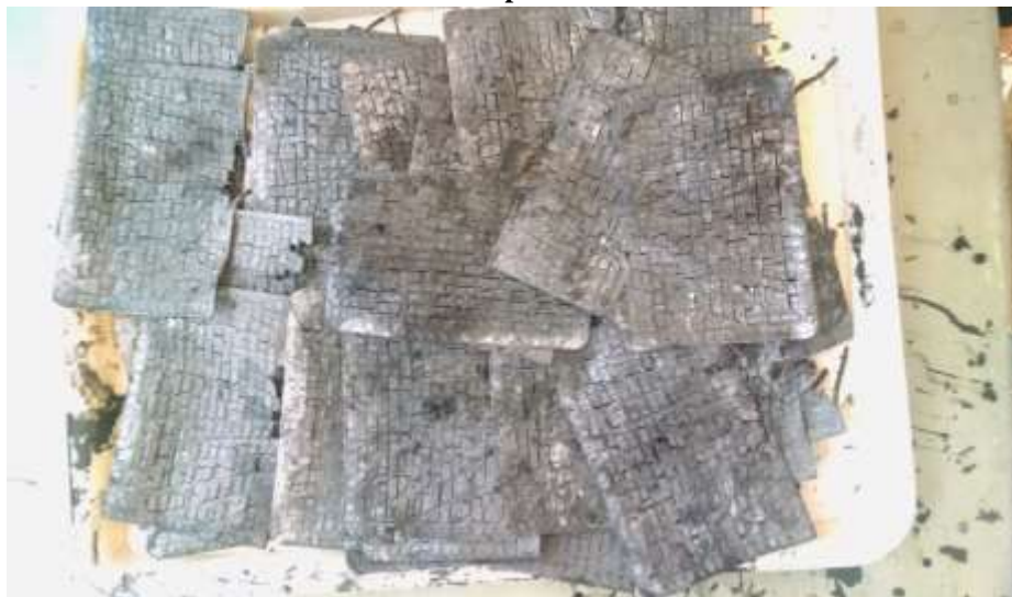
Figura 2-4. Celdas internas de las baterías de plomo usadas
