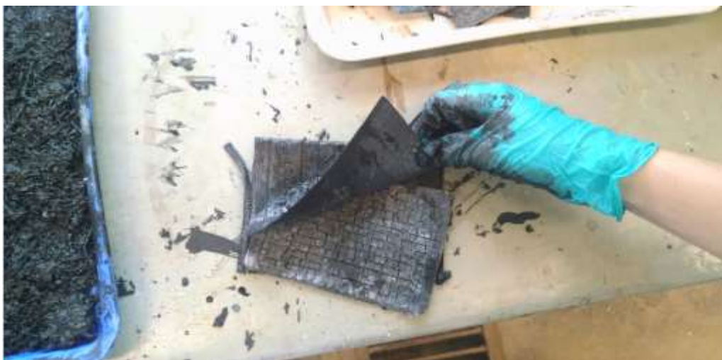
Figura 2-3. Celdas internas de las baterías de plomo usadas
