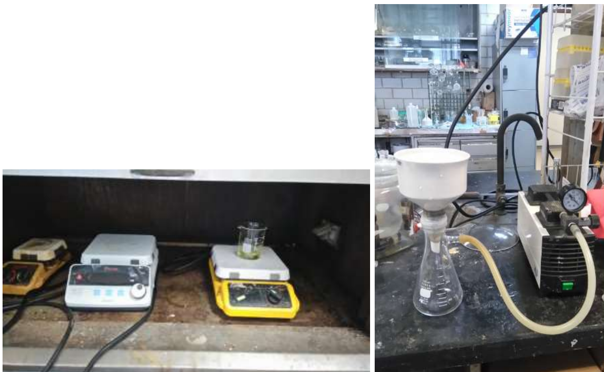
Figura 2-7. Digestión ácida de muestra de cabeza de muestra sólida
