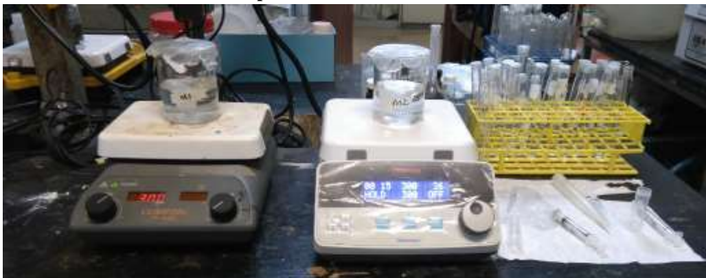
Figura 2-10. Toma de muestras en las pruebas de lixiviación con citrato de sodio
