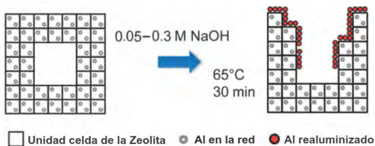
Figura 4-6: Representación esquemática de la desilicación por medio del tratamiento alcalino con hidróxido de sodio (NaOH) [18].
