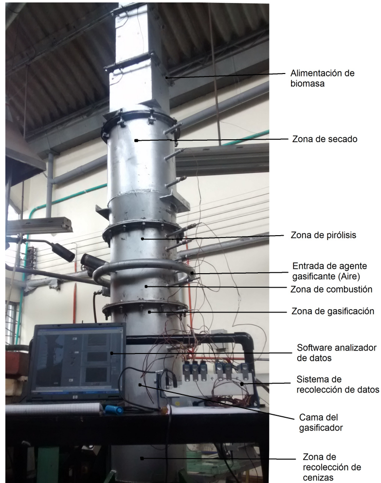
Figura 6-3: Gasificador de lecho fijo y corriente descendente con sistema de recolección y análisis de datos
