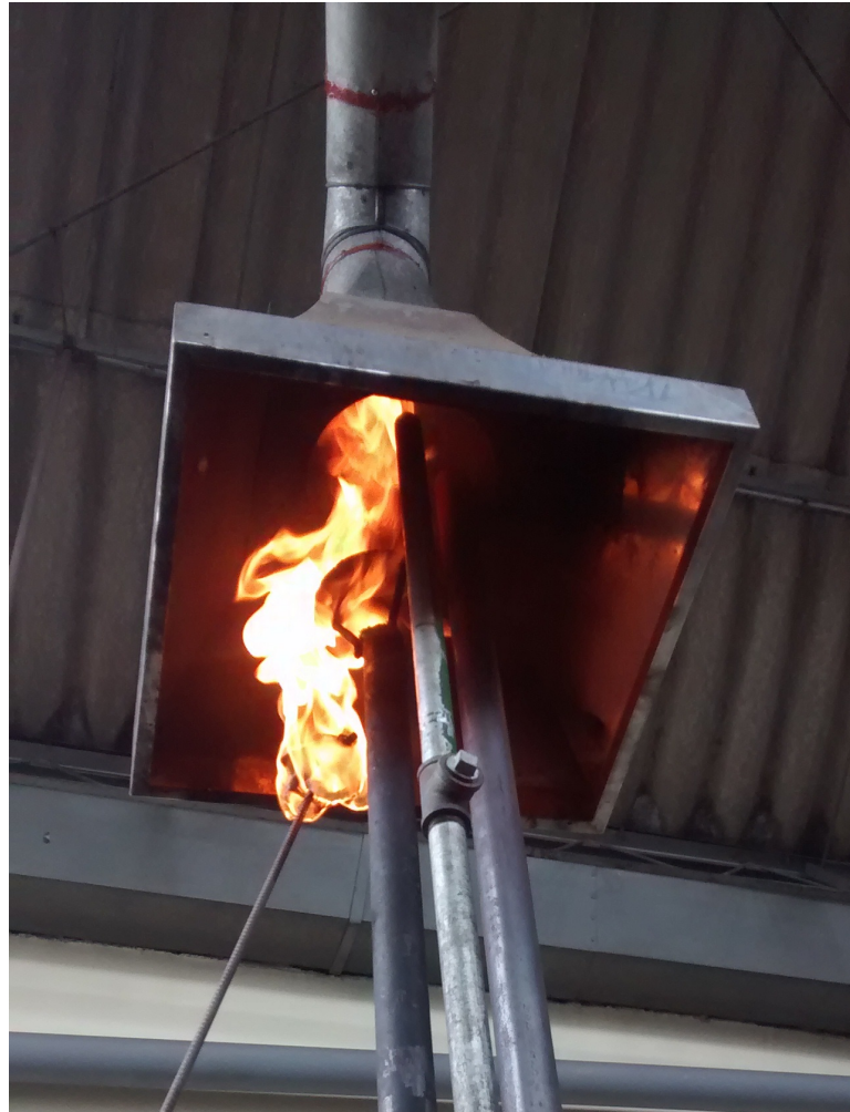
Figura 7-8: Salida gas producto de gasificación
