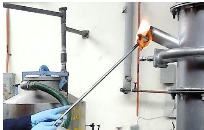
Figura 7-6: Encendido del gasificador por el ducto de succión
