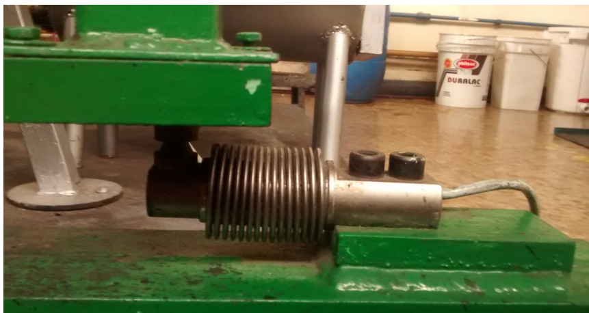
Figura 6-7: Celdas de carga del gasificador (Tomado de [72])
