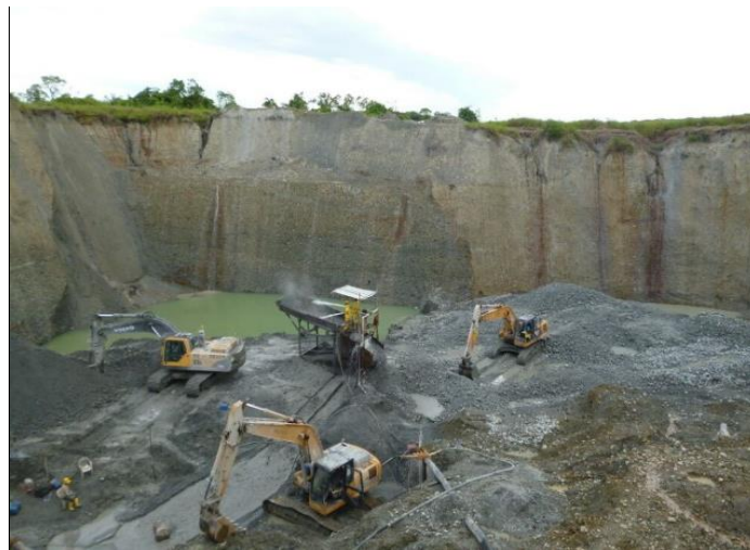
Figura 11 Sistema de explotación con retroexcavadora
