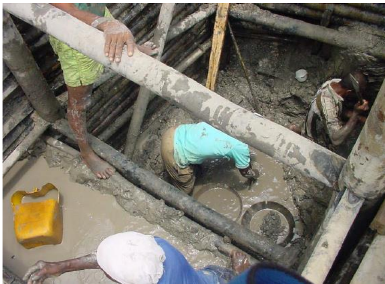
Figura 8 Avance en el sistema de explotación Guache
