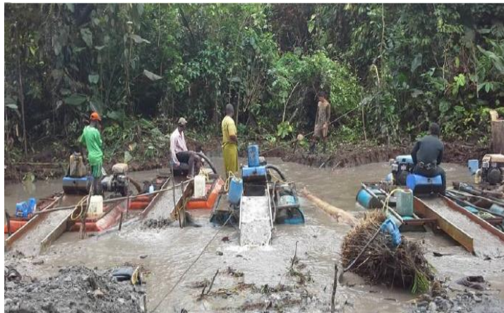
Figura 10 Sistema de explotación con draguetas
