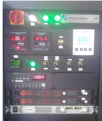
Gráfica 3.1 Sistema para la fabricación de muestras por método DC magnetron Sputtering, con dispositivo de controles
