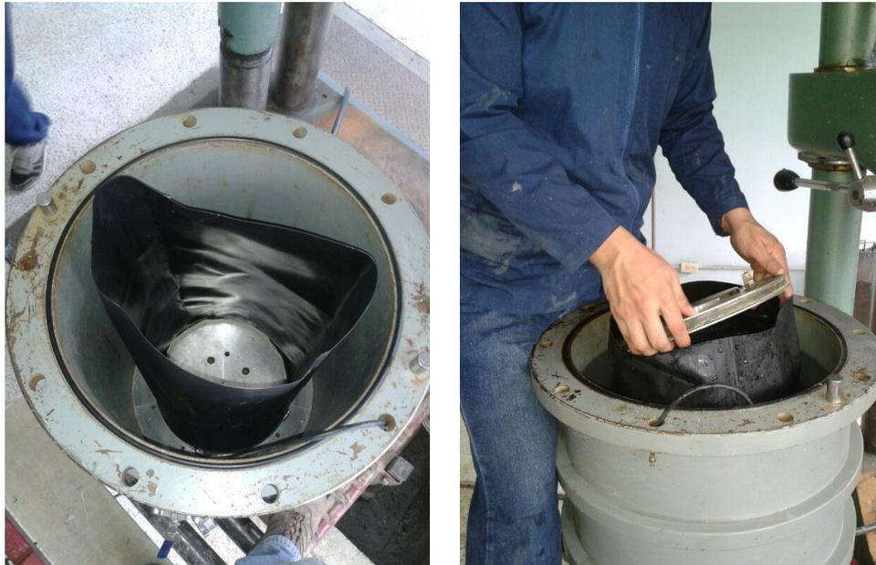
**Figura 3-21.** Membrana y formaleta para conformación de muestra dentro de la cámara.
