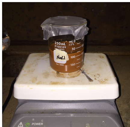
Figura 2-2. Montaje pruebas de lixiviación preliminares.
