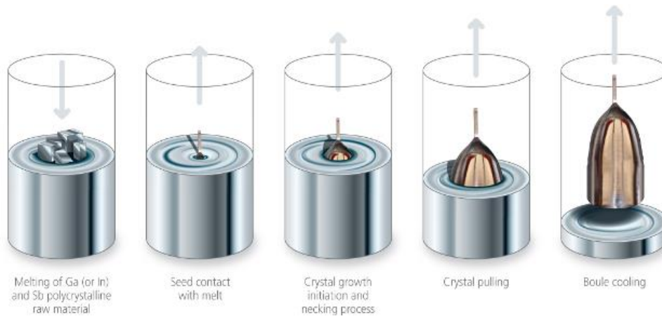
Figura 1- 6: Diagrama esquemático para el crecimiento de cristales semiconductores a través del método Czochralski [11].
