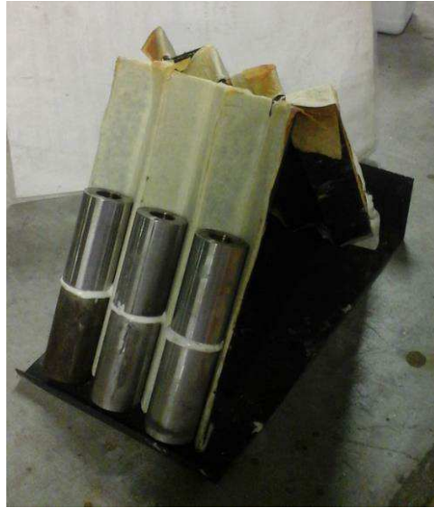
Figura 16. Montaje de probetas para el ensayo de adhesión.
