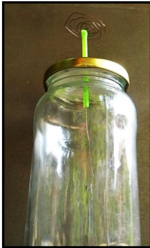
Figura 5-17: Conjunto electroscopio completo (Autor)
