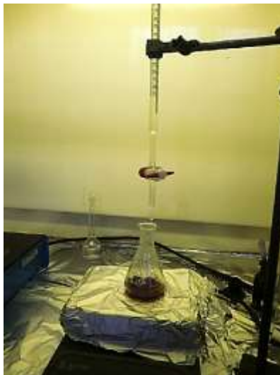
Figura 2-5. Montaje para la determinación de azúcares reductores por el método de Lane y Eynon
