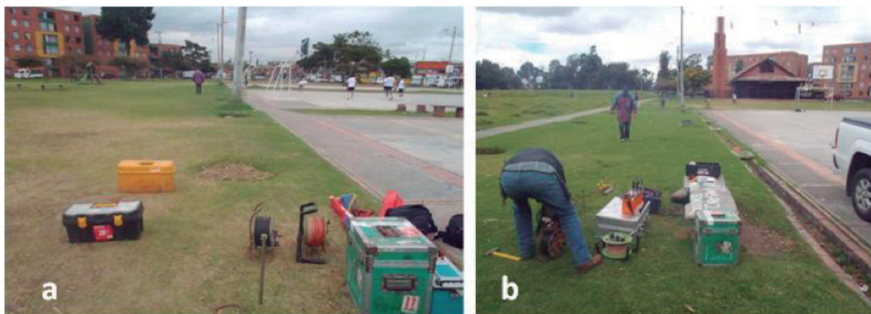
Figura 6. Adquisición de datos de resistividad eléctrica en las zonas verdes contiguas al templo mediante Sondeos Eléctricos Verticales y tomografía eléctricas mediante el arreglo Wenner - Schlumberger (a) vista hacia el Oeste (b) vista hacia el Este.
