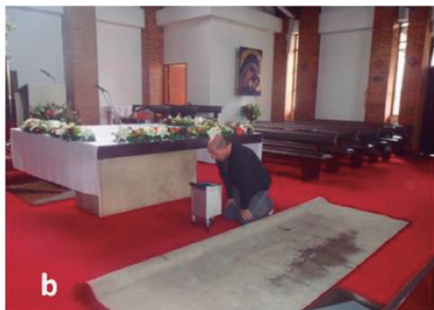
Figura 2. Adquisición de datos de microgravimetría mediante una grilla de 1m x 1m (a) en el atrio de la iglesia (b) en el interior del templo.
