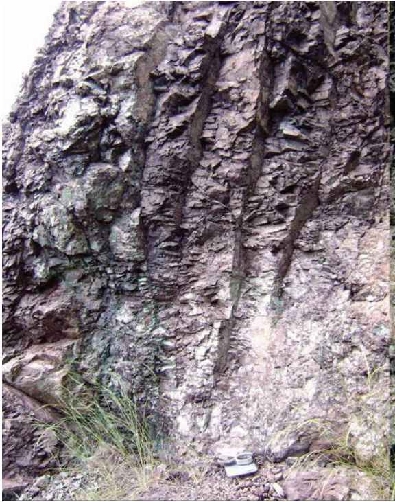
Figura 4. Potente afloramiento de la Unidad La Quinta Sedimentaria (JLQ), en el sector de Zabaneta, se observan fracturamiento y diaclasamiento así como la presencia de sectores mineralizados (Mi), N 1.627.641, E 1.099.871, H 434 m
