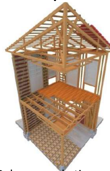
26. Bahareque de tierra sobre columnas de madera
