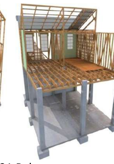
31. Bahareque encementado sobre columnas de cemento armado
