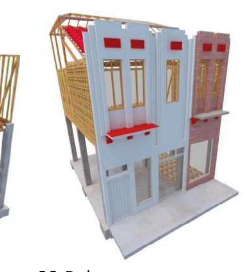
32. Bahareque encementado sobre columnas de cemento armado con fachada en mampostería
