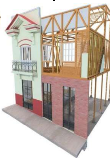
30. Bahareque encementado y mampostería sobre columnas de madera
