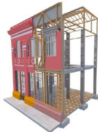
34. Pórticos de cemento armado y bahareque encementado
