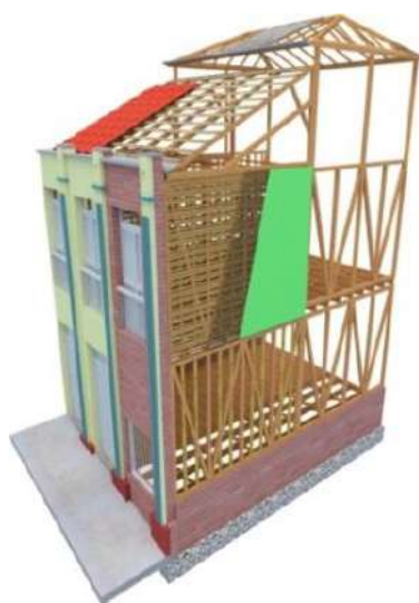
28. Bahareque encementado con fachada en mampostería
