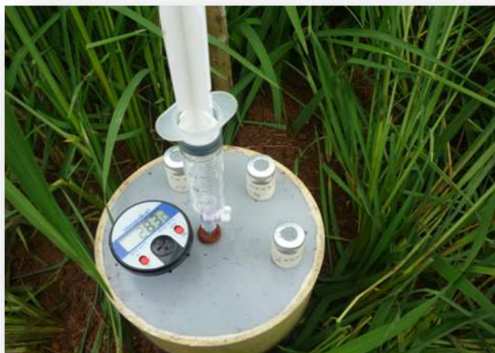
Figura 10. Cámara instalada en campo para el monitoreo de los gases efecto invernadero \text{CO}_2 , \text{NO}_3 y \text{CH}_4 .
