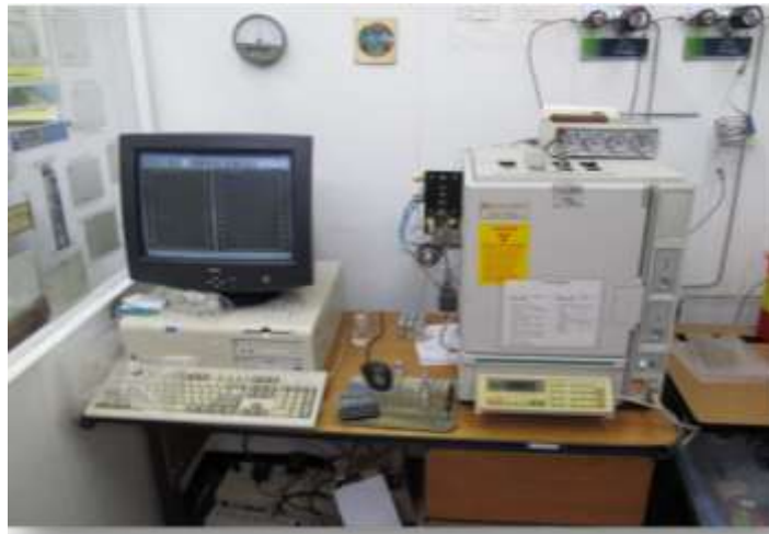
Figura 14. Cromatógrafo de gases utilizado para análisis de metano y óxido nítrico.
