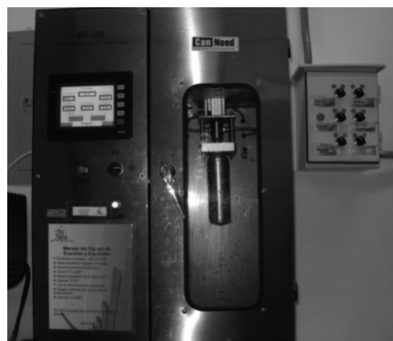
Figura 6. Equipo probador de resistencia de envases metálicos.
