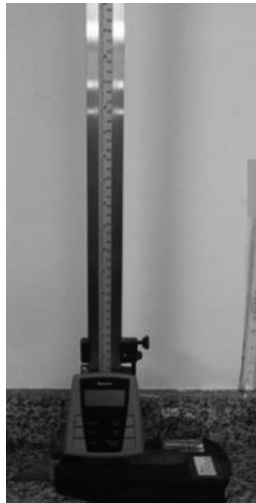
Figura 3. Calibrador electrónico de altura.
