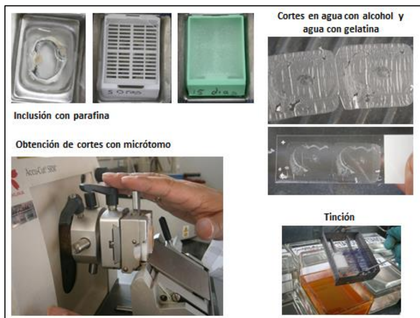
Figura No. 1. Procedimiento para la preparación de la muestra (Fuente: Peña, G. 2016)
