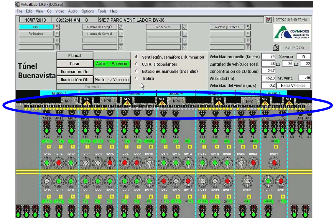
Figura 33. Luminarias operan con el nuevo algoritmo, portales independientes, Interior2 apagado siempre
