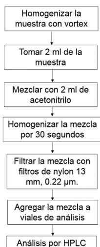
**Figura 4.4.** Procedimiento para la extracción de explosivos a partir de muestras acuosas.
