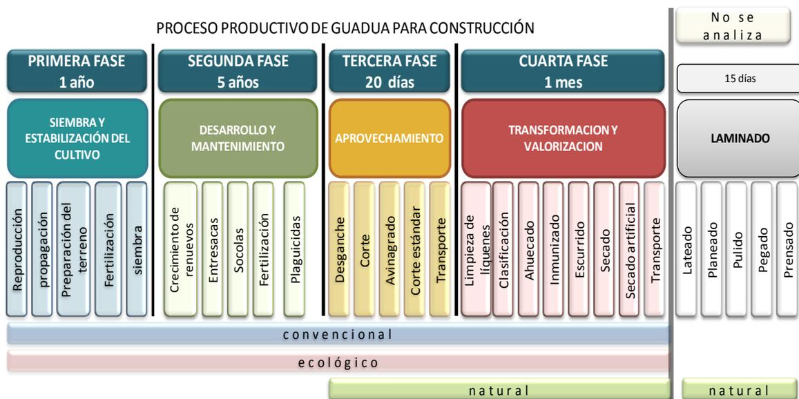
Figura 2. Proceso de producción de guadua para construcción (Fuente: Elaboración del autor).
