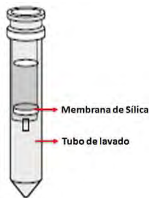
Figura 9. Montaje para la separación y purificación de ADN plasmídico.
