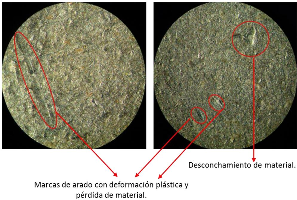
**Figura 3-11. Fotografía probeta, lámina termotratada grupo 5 y 7.**
