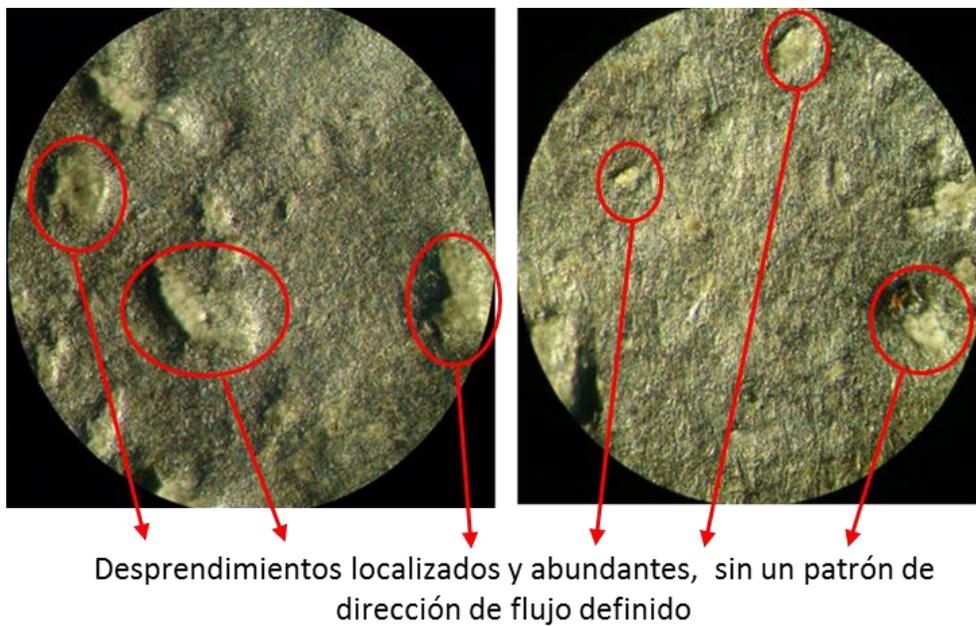
Figura 3-9. Fotografía probeta, lámina termotratada grupo 4.
