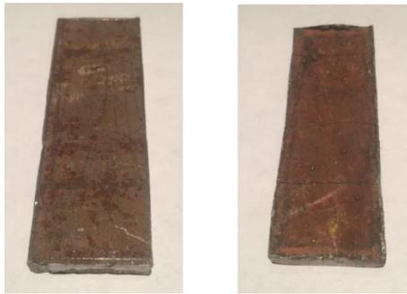
Las muestras recubiertas con silicona Figura 2-14, fueron obtenidas a partir de una base metálica y un recubrimiento posterior. La base metálica fue recortada en unidades con las dimensiones sugeridas en la norma ASTM G65, a partir de una platina de acero A-36 y con dimensiones 25,4 mm x 6000 mm x 3 mm.
