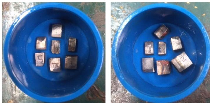
Luego del tiempo de curado, son retiradas del molde y se procede a la preparación superficial mediante pulimento, utilizando papel de lija de diferentes granulometrías, desde N°80, N°150, N°240, N°420, N°600, N°1200 y paño.
