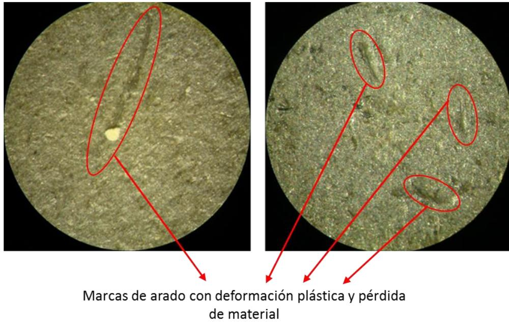
**Figura 3-12. Fotografía probeta, lámina termotratada grupo 3 y 8.**
