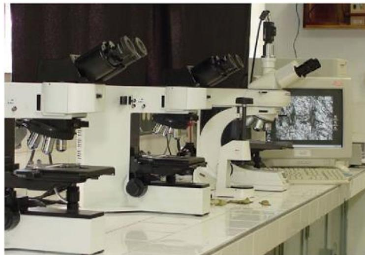
Este microscopio posibilita la observación de la distribución y el tamaño de los granos o cristales que constituyen el material, las diferentes fases presentes, los bordes de grano entre otras características como se observa en la Figura 1-27. Adicionalmente dispone de un sistema de iluminación que hace incidir un haz de luz sobre la superficie de estudio y recoge el haz reflejado. [43,44]
