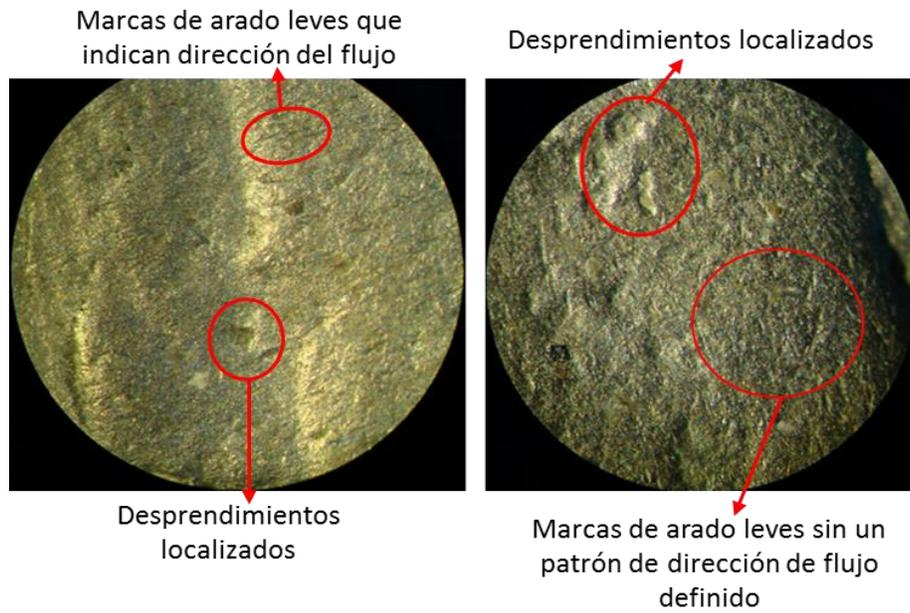
**Figura 3-7. Fotografía probeta, lámina recubierta grupo 5 y 7.**
