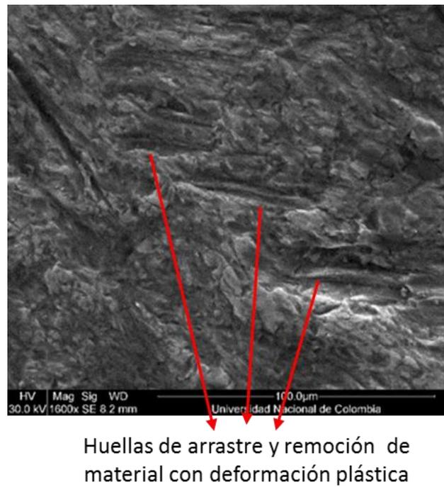
Figura 3-23. Fotografía SEM probeta, lámina recubierta grupo 7.
