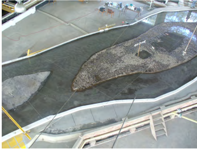
Figura 6.4: Toma del modelo físico del tramo del río Magdalena simulado (3).
