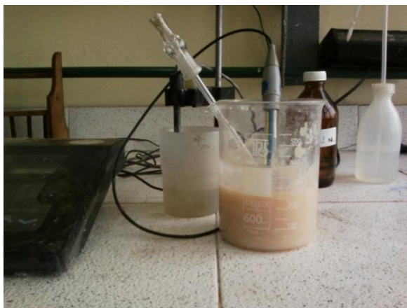
Imagen 5. Medición y ajuste de pH de la mezcla
