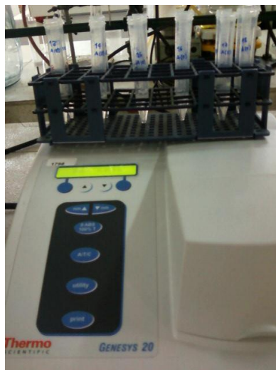
Imagen 11. Medición absorbancia para determinación propiedad emulsificante
