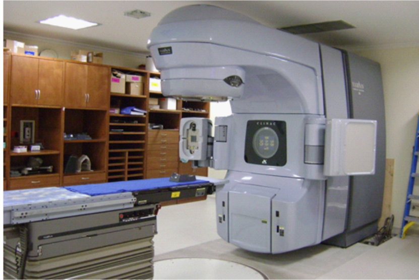
Figura 4.1: Acelerador lineal iX , instalado en el Instituto Nacional de Cancerología; tiene dos energías de fotones (6 y 18MV) y 5 energías en Electrones (6, 9, 12, 15 y 18 MeV)
