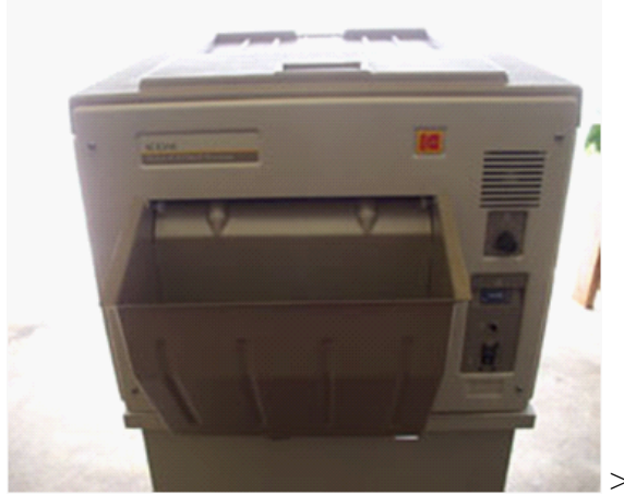
Figura 4.8: Procesador disponible en el Instituto Nacional de Cancerología, para el proceso de revelado de placas radiográficas EDR-2
