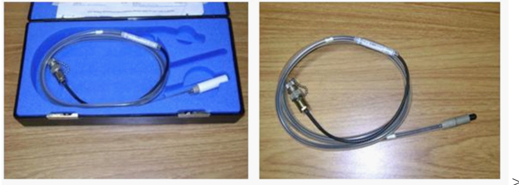
Figura 4.3: Cámara de ionización tipo CC 13, el volumen nominal activo es de 0.13 \text{ cm}^3
