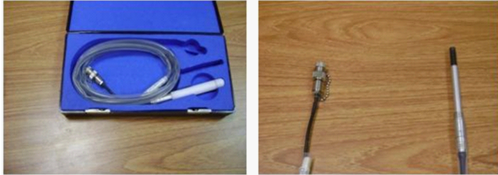
Figura 4.4: Cámara de ionización tipo Farmer; el volumen nominal activo es de 0,69 \text{ cms}^3
