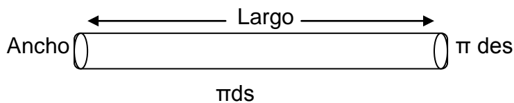
Figura 25. Área del espiral (desarrollo de tubería de cobre). Fuente: Autor
