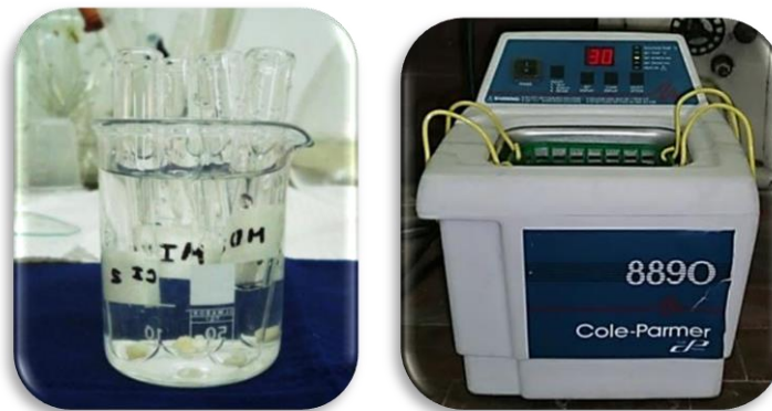
Muestras sumergidas en agua desionizada listas para ser lavadas con ultrasonido.
