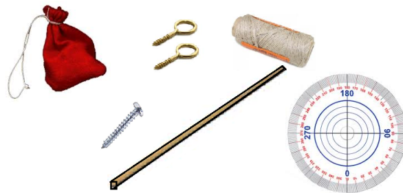
Figura 4.4: Materiales para la construcción del goniómetro
