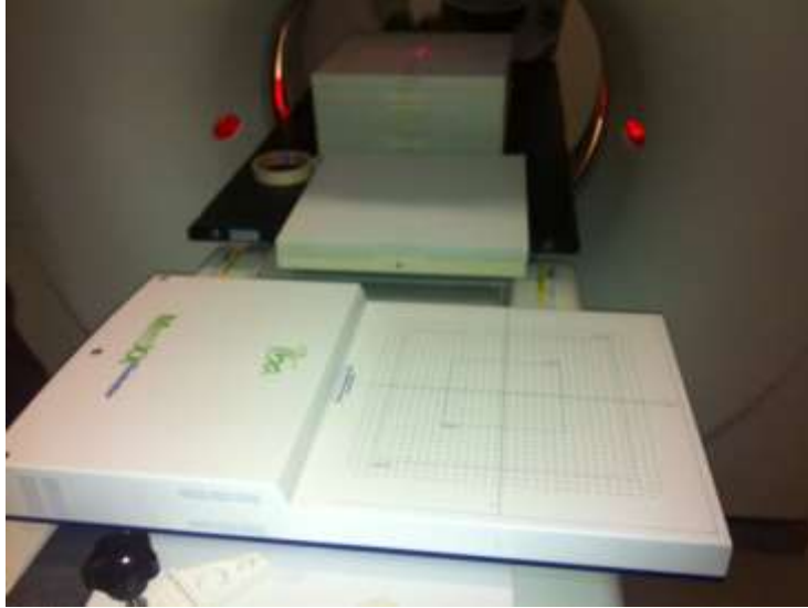
Figura40. Sistema MatriXX para la verificación de la distribución de dosis
