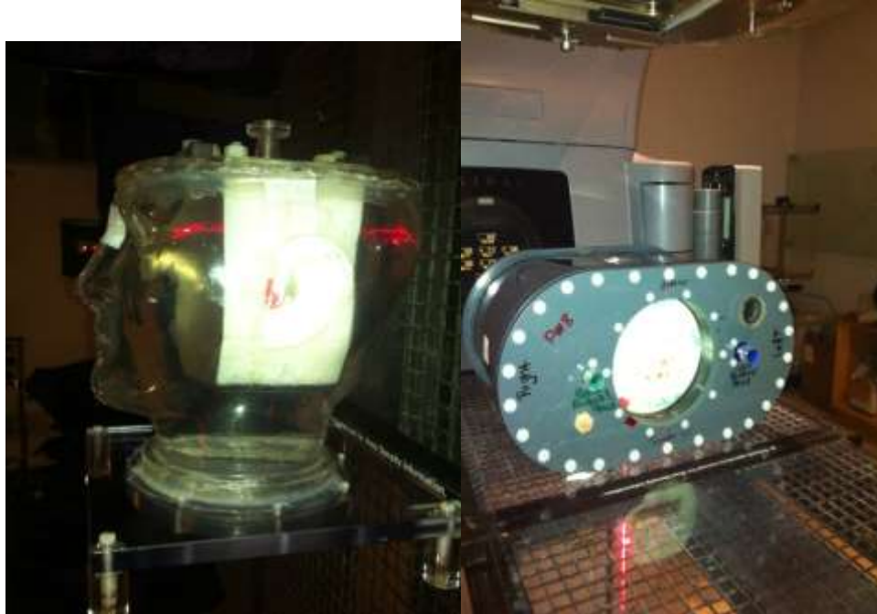
Figura21. Phantoms antropomórficos del RPC cabeza y cuello y pelvis
