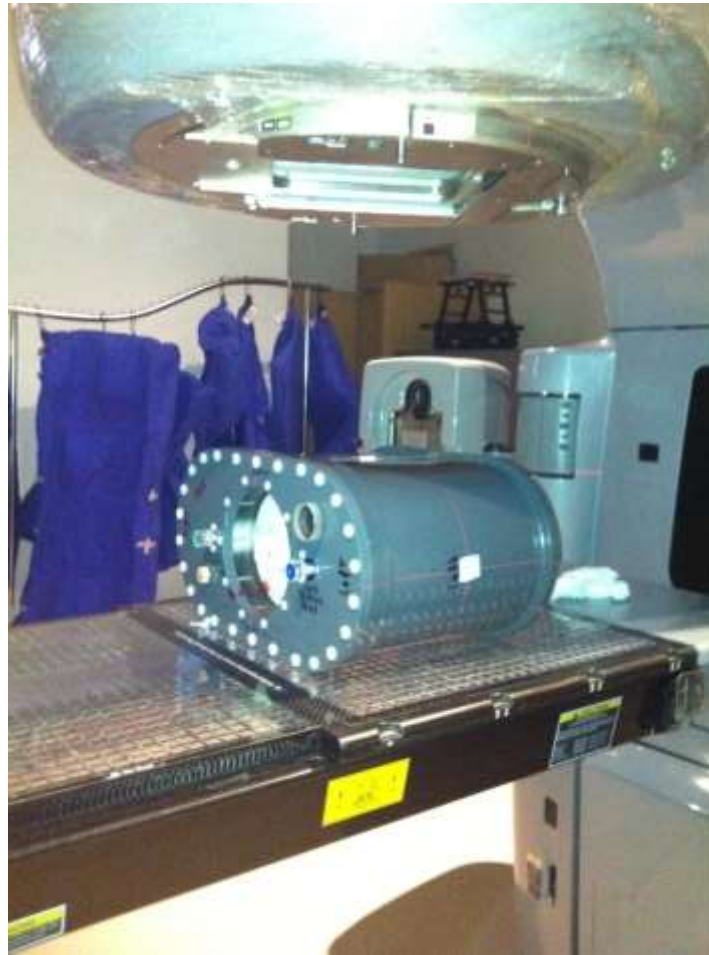
Figura53. Irradiación Phantom antropomórfico de próstata técnica RapidArc® acelerador iX
