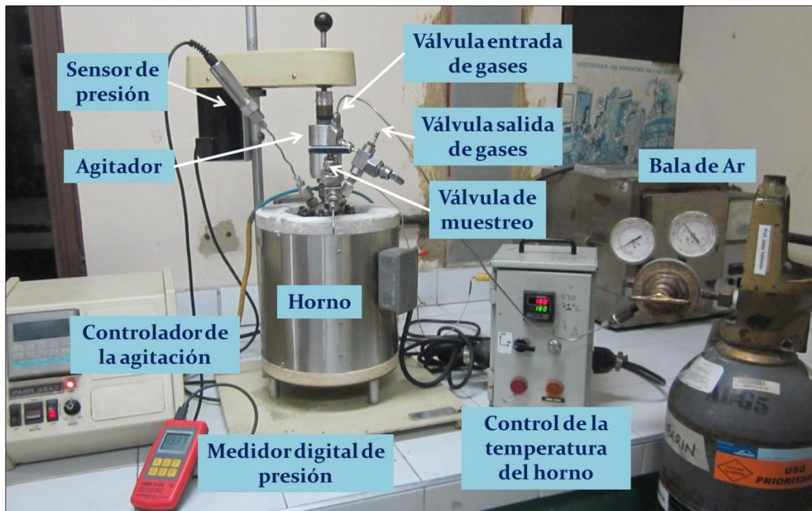
Antes de iniciar la reacción el sistema se purga tres veces con Argón y se presuriza con este mismo gas a una presión de 5 bar. La rampa de calentamiento fue de 10 °C/min hasta la temperatura de reacción (180 °C). Al alcanzar esta temperatura, el sistema llega a una presión entre 20 y 21 bar.
