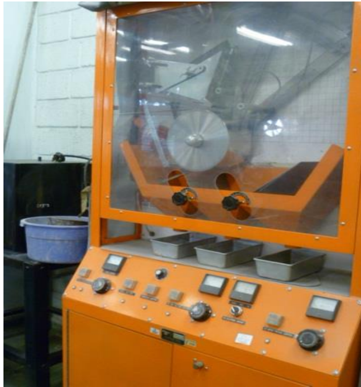
Figura 2-5. Separador electrostático utilizado en el proceso de concentración.
