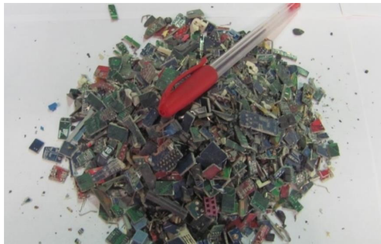
Figura 3-1: Material después del corte manual con cizalla.
