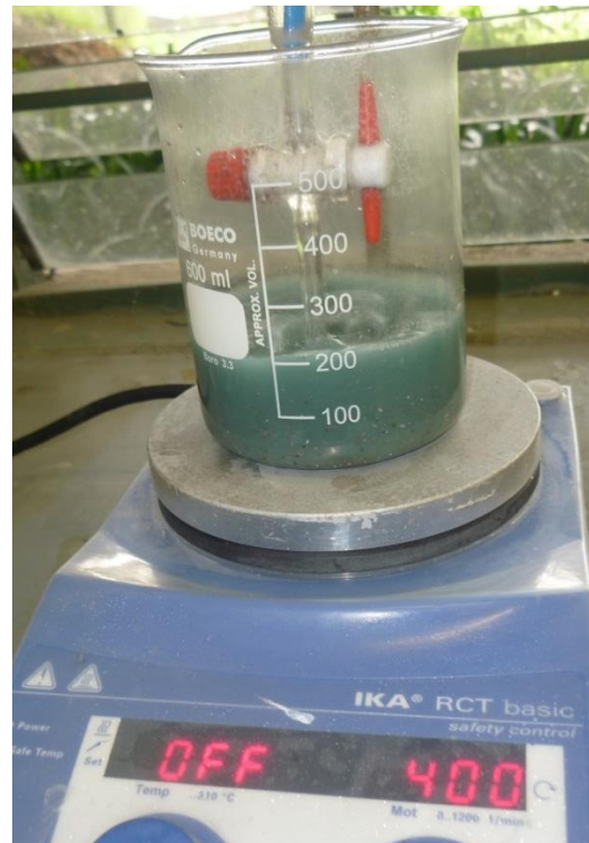
Figura 3-41: Prueba de lixiviación de cobre con O_2 .
