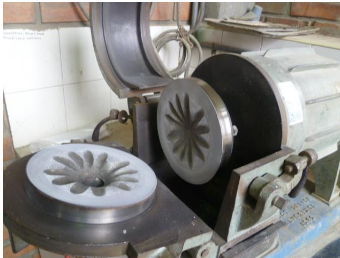
Figura 2-3: Pulverizador utilizado en la reducción de tamaño.
