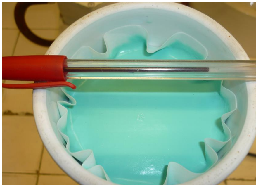
Figura 3-10: Filtración del oxiclорuro de cobre precipitado.
