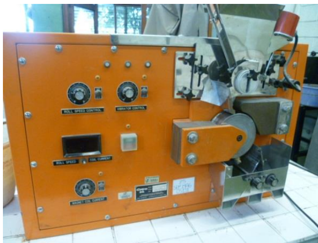
Figura 2-4: Separador magnético utilizado en el proceso de concentración.
