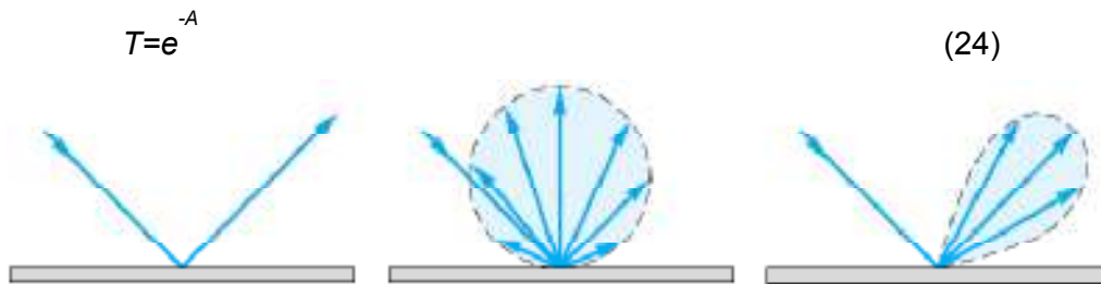
Figura 1-14. Reflexión especular, difusa y dispersada de una superficie[28].
