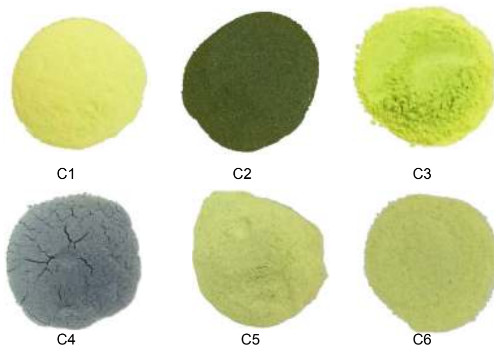
Figura 3-16. Color tonal desarrollado que presentan los pigmentos sintetizados mediante el método sol-gel y calcinados a 650°C.
