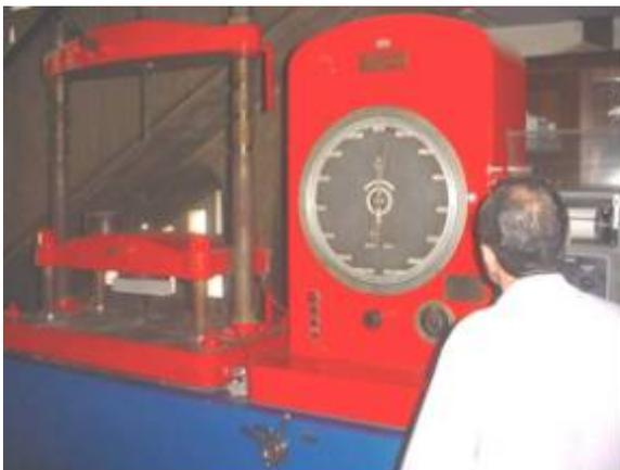
**Figura 42. Aplicación de carga**
