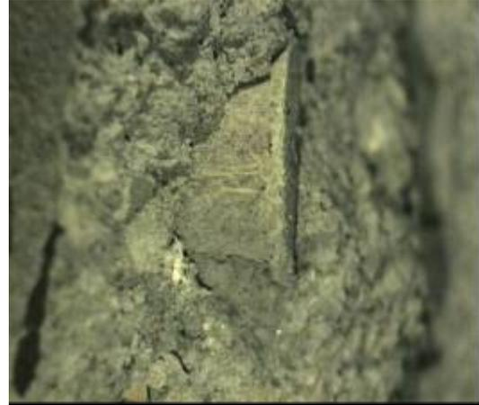
Para el caso de las vigas reforzadas con acero, el recubrimiento no era tan bueno como si lo fue para las vigas reforzadas con barras de FRP. Esto garantiza la compatibilidad entre la matriz cementante de hormigón y el nuevo material de refuerzo.
