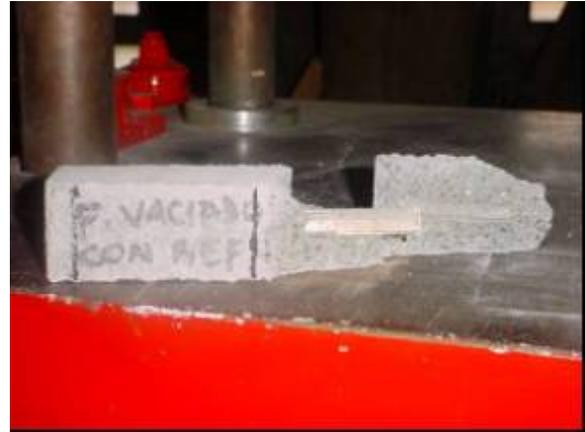
En la Figura 45 están las vigas reforzadas con acero convencional elaboradas con arena de Ottawa (arena normalizada) y Canteras de Colombia (normal).
