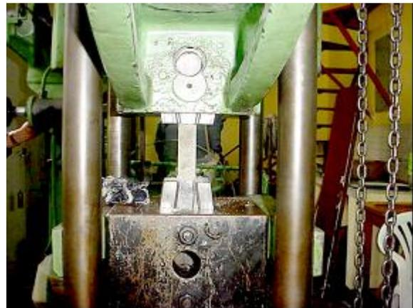
Las dimensiones de las probetas para la prueba cuantitativa de la adherencia tenían dimensiones según la especificación NTC-220; pero al momento de fijarlas a las mordazas de la prensa universal, fue necesario recortar uno de los extremos en aproximadamente un centímetro y medio. Quedó un extremo de la probeta (Mortero FRP) con una longitud de 8cm y sección 5X5 cm<sup>2</sup>; el otro extremo quedo de una longitud de 6.5cm y una sección de 5x5 cm<sup>2</sup>.
