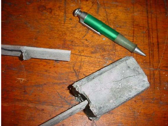
**Figura 75. Extremos de mortero deslizados y extremos fijos de hormigón con FRP**
