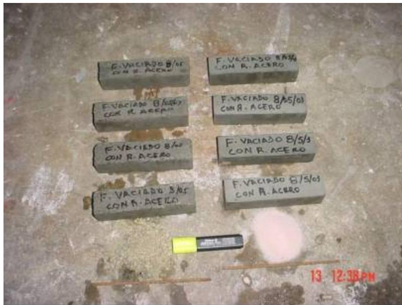
Para la elaboración de las probetas que se llevaron a la prensa universal de tres toneladas para la evaluación cuantitativa de la adherencia, se diseñó un tipo de
