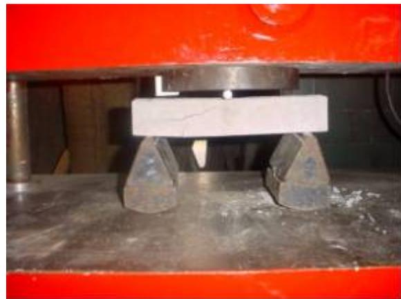
**Figura 43. Falla de la probeta y grieta proyectada.**
