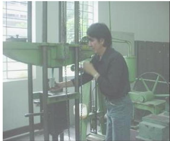
**Figura 48. Probetas fijadas a las mordazas en la prensa de 3 T**
