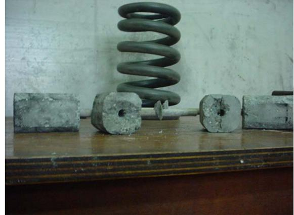
1. Las probetas para la prueba cuantitativa de adherencia entre el mortero y el FRP fueron diseñadas sin seguir algún tipo de normativa. La idea consistió en crear la manera de fijar las probetas a los dispositivos existentes en el laboratorio de metalografía de la Universidad Nacional sede Medellín.
