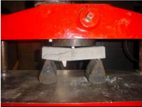
**Figura 44. Aspecto de la probeta fallada y desmontada**
