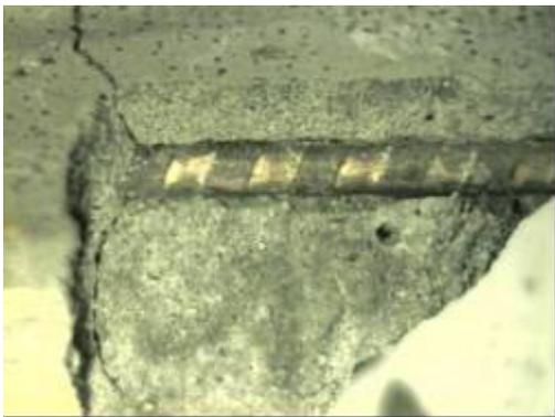
**Figura 69. Superficie del mortero dejada por el refuerzo**
