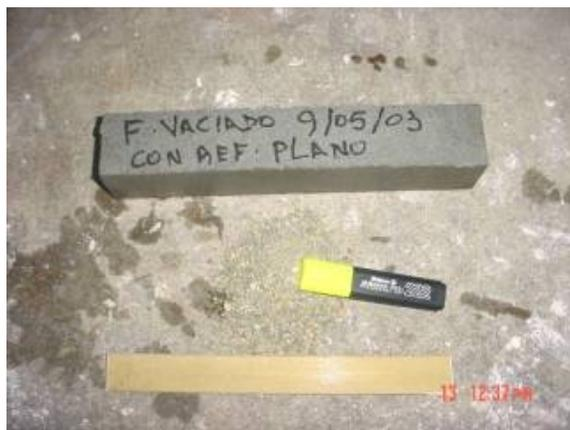
**Refuerzo** : Fibra polimérica plana de espesor  $e=5.0$  mm
