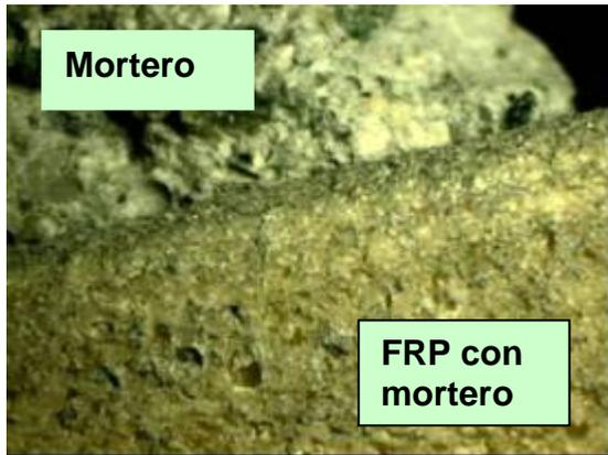
**Figura 29. Sección transversal de la probeta (Durglass)**
