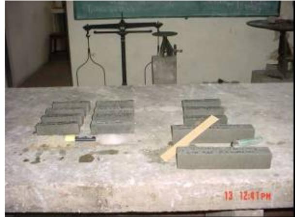
Fue necesario fijar el refuerzo en los extremos de las formaletas, esto debido al bajo peso de las barras de FRP, que tienden a flotar en las mezclas de mortero fresco durante el vaciado. Una vez elaboradas las probetas se pesaron y fueron llevadas al tanque de curado, para ser falladas a los siete y veintiocho días.
