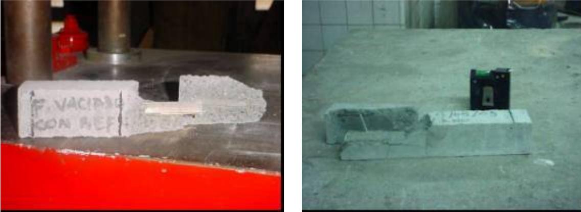
**Figura 58. Falla de probeta reforzada con FRP de diámetro de 21.86 mm**
