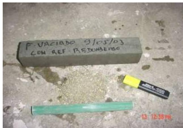
**Refuerzo** : Fibra polimérica se sección circular de  $d = 21.86 \text{ mm}$
