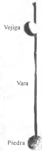
FIGURA A 1.4. ENSAYOS DE CAMPO REALIZADOS POR LEONARDO DA VINCI PARA MEDIR LA VELOCIDAD DEL AGUA EN UN CANAL. FUENTE: VEN TE CHOW ET AL. HIDROLOGÍA APLICADA
