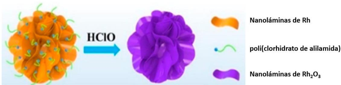
**Figura 17:** Ilustración de la síntesis de  $\text{Rh}_2\text{O}_3$ .
