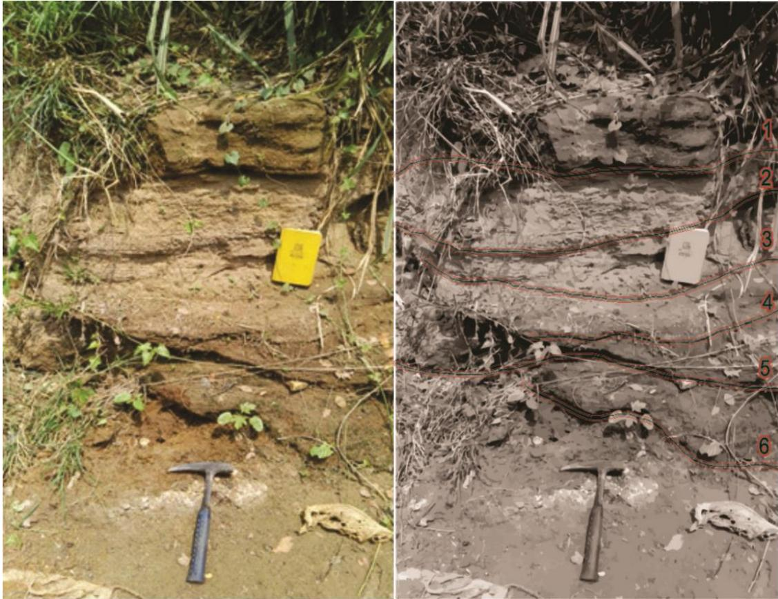
Fotografía 13. Identificación de sedimentos y estructuras asociadas con pulsos de inundación, diferenciación del sorteamiento de la granulometría, sector el Cádiz, Puerto Peñalisa.
