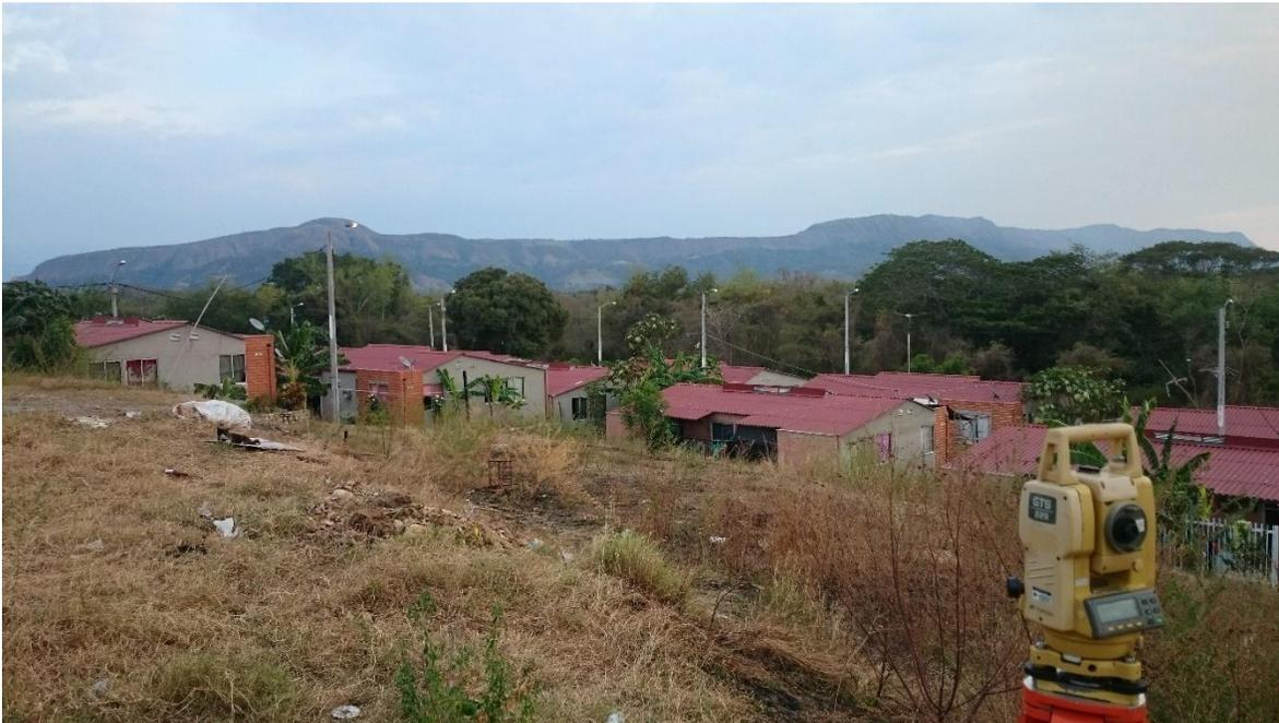
Fotografía 2. Levantamiento topográfico con estación. Arriba: Sector Barrio Villa Carolina.
