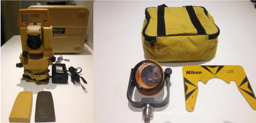
Fotografía 1. Estación Total Topográfica Topcon GTS 236W y Tipo de Prismas utilizados en levantamiento topográfico.
