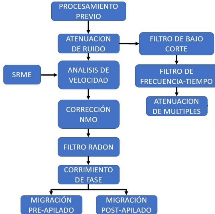
Figura 9 Flujo de procesamiento marino, empleado en el procesamiento de la línea sísmica 2D “Línea 1”.
