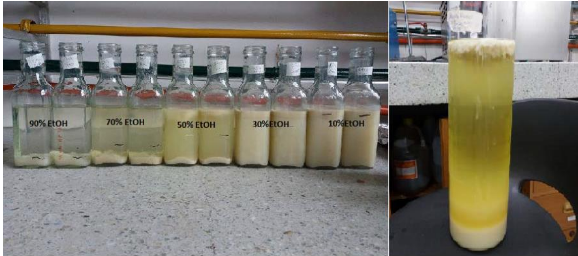
Figura 2-23: Resultados del experimento de precipitación de biomasa con etanol
