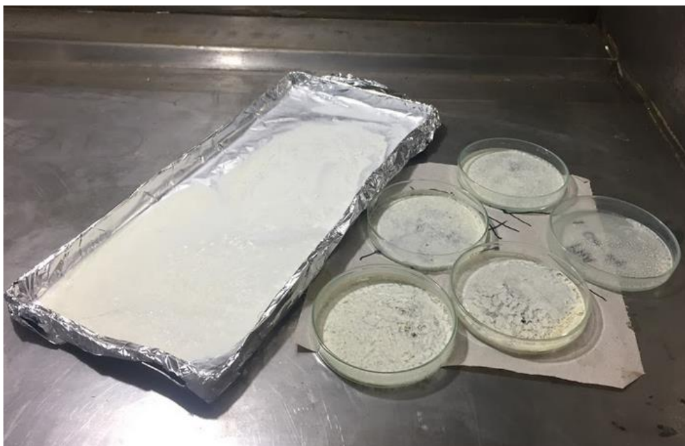
Figura 1-9: Polímero obtenido después del tratamiento con SDS/Cloroformo/Hipoclorito [106].
