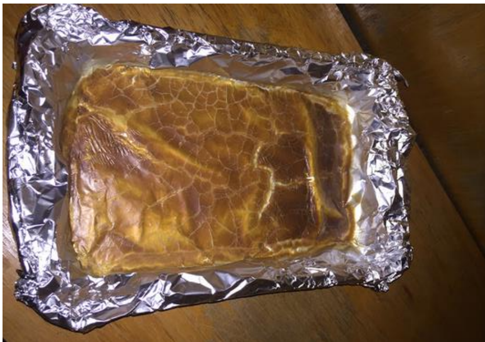
Figura 1-10: Material extraído usando extracción con SDS y purificación con cloroformo.
