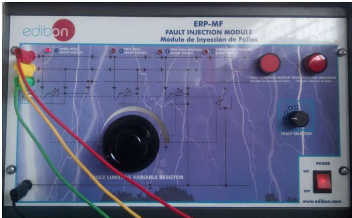
Figura 27. Módulo de inyección de fallo en la posición 1 (fallo trifásico).
