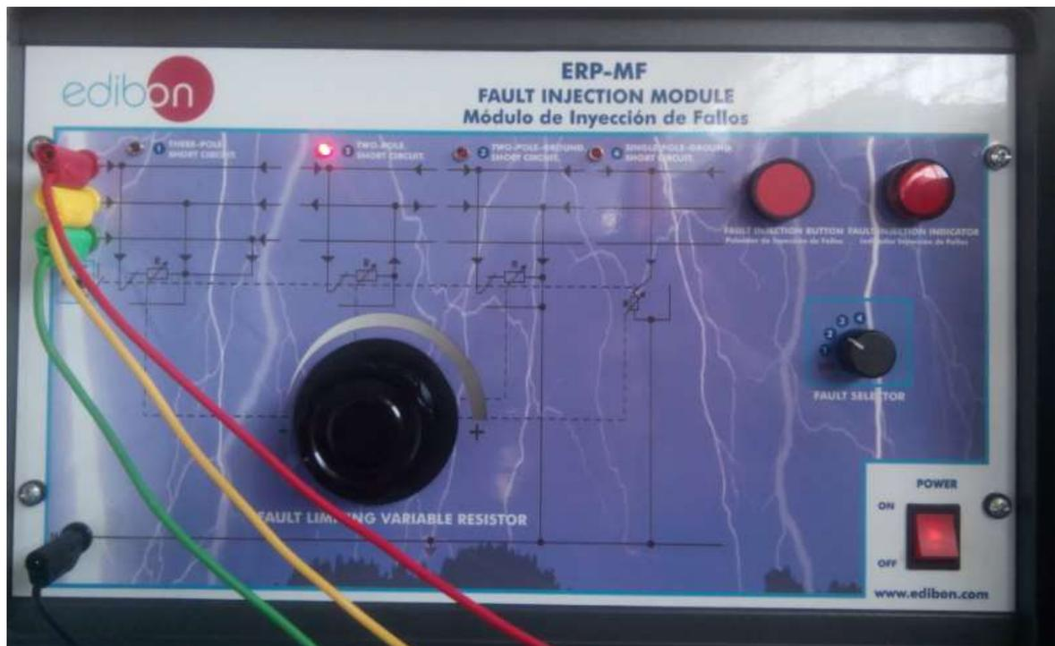
Figura 25. Módulo de inyección de fallo en la posición 2 (fallo bifásico).
