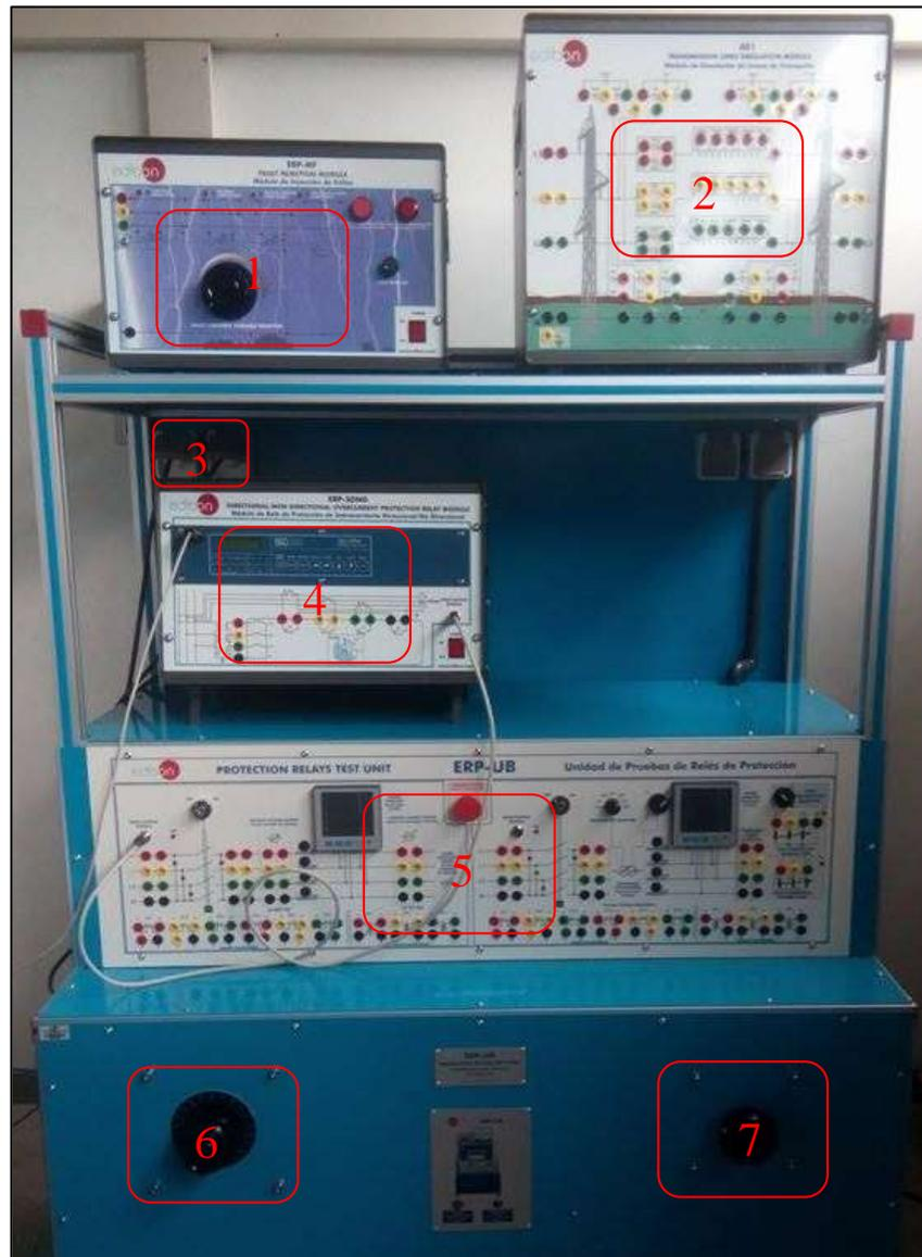
Figura 3. Unidad de Ensayo de Relés de Protección ERP-UB.
