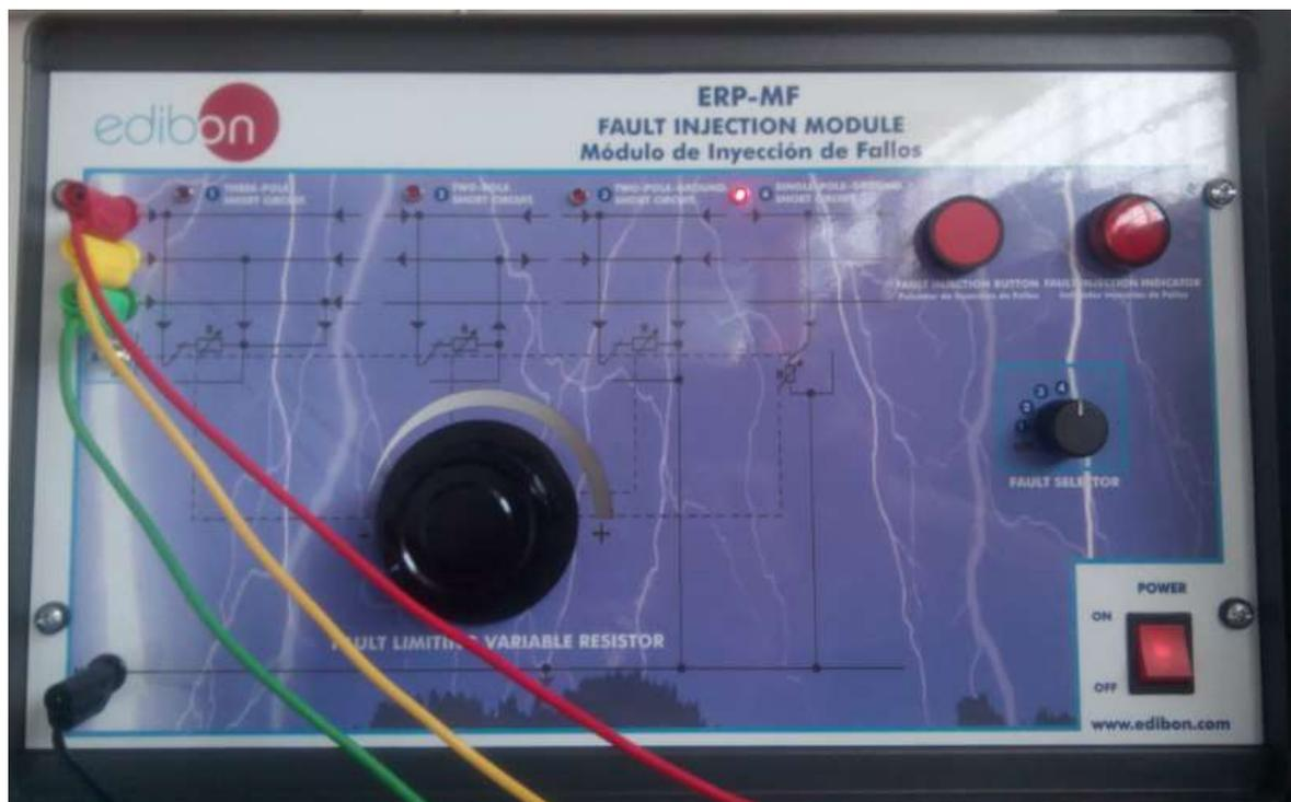
Figura 21. Módulo de inyección de fallo en la posición 4 (fallo monofásico a tierra).
