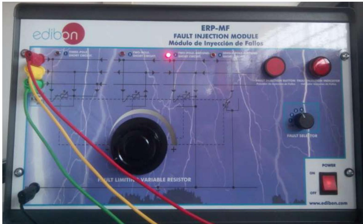
Figura 23. Módulo de inyección de fallo en la posición 3 (fallo bifásico a tierra).
