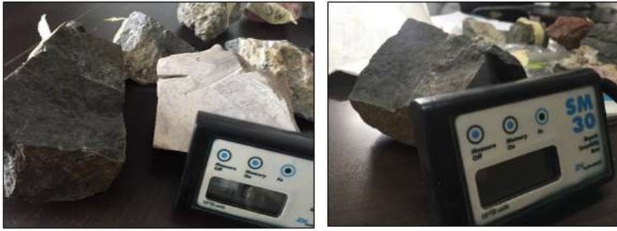
Figura 3-1. Toma de susceptibilidad magnética en muestras de roca de la Isla de Providencia.
