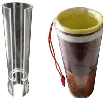
**Figura 4-3:** Dispositivo utilizado para la estimulación magnética con su respectiva base la cual fue fabricada en PMMA y garantiza que las cajas de cultivo estén estimuladas con la misma magnitud de CM.
