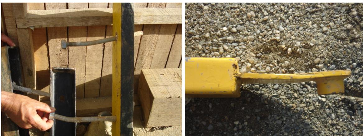
Figura 35. Falla de pernos por deformación excesiva, cizalladuras en pernos y en diagonales. Situaciones corregidas.
