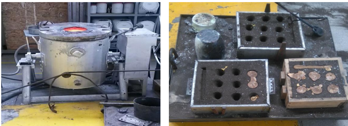
Figura 2-7. Horno detenido para vaciado del material / piezas obtenidas colada 1.
