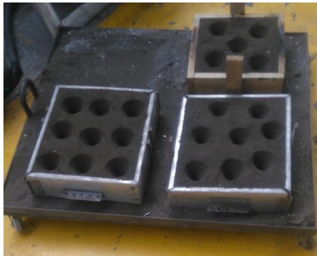
Figura 2-5. Moldes de arena en verde. Fuente: Autor.
