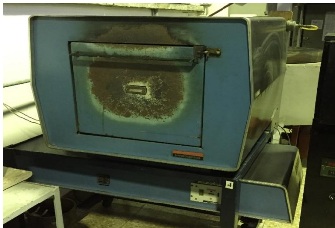
Figura 2-12. Horno Mufla Lindenberg.
