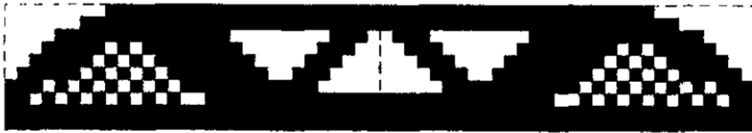
Fig. 4-14.: Estructura con problema de tablero de ajedrez. Imagen tomada de Sigmund and Petersson (1998) .
