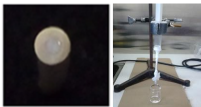
Figura 4-29. Columna de PEEK- poli (BMA- co -EDMA- co -GMA), con tratamiento de paredes y polimerización exitosa y montaje de llenado
