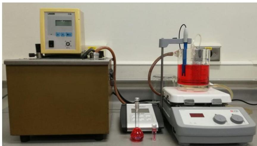
Figura 2.1. Montaje de reacción para la evaluación catalítica de arcillas modificadas en CWHPO del colorante rojo Ponceau 4R.
