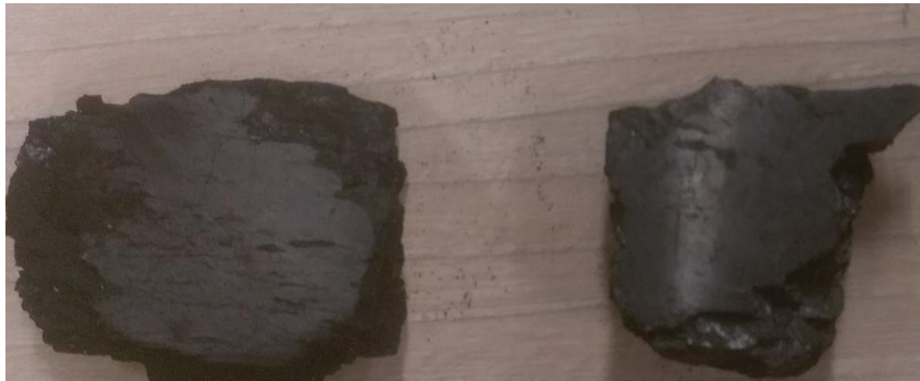
Figura 4-2. Muestras pulidas para el análisis de ángulo de contacto para la medición de la tensión superficial del carbón.
