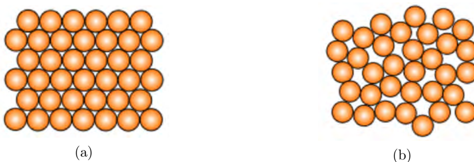
Figura 2.1: Diferencia de estructura entre: (a) material cristalino y (b) material amorfo. Tomado de [5]
