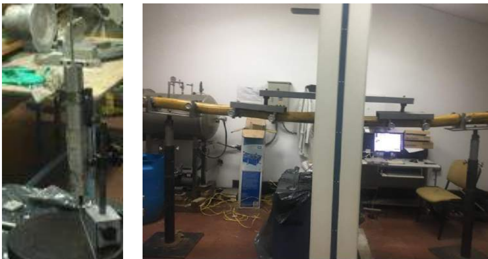
Figura 5-10 Montaje para el ensayo de flexión
