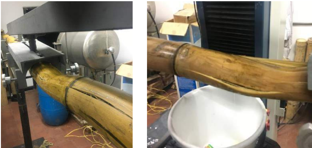
Figura 5-13 Fallas típicas del ensayo de flexión. Fuente: autor.
