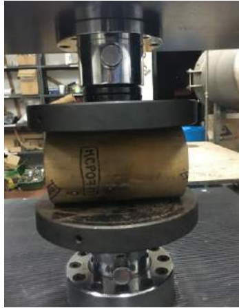
Figura 5-8 Montaje del ensayo de compresión perpendicular a las fibras. Fuente: autor.
