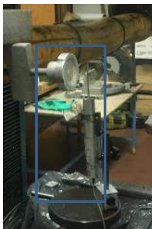
Figura 5-12 Montaje del ensayo de flexión. Fuente: Autor.
