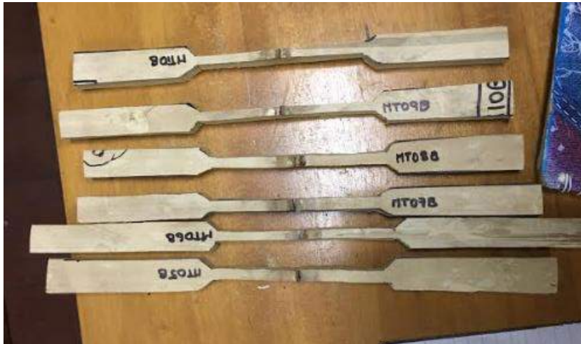
Figura 5-20 Preparación de las probetas del ensayo de tensión paralela a las fibras. Fuente: autor.
