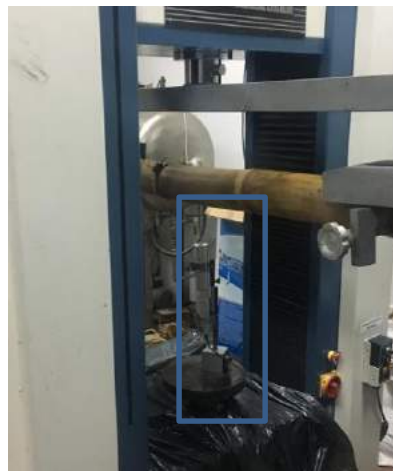
Figura 5-12 Montaje del ensayo de flexión. Fuente: Autor.
