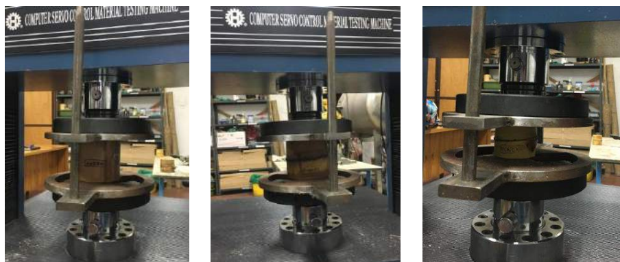
Figura 5-17 Montaje del ensayo de corte paralelo a las fibras. Fuente: autor.
