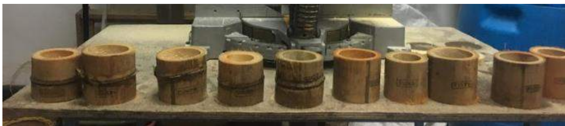
Figura 5-16 Preparación de las probetas de corte paralelo a las fibras. Fuente: Autor.
