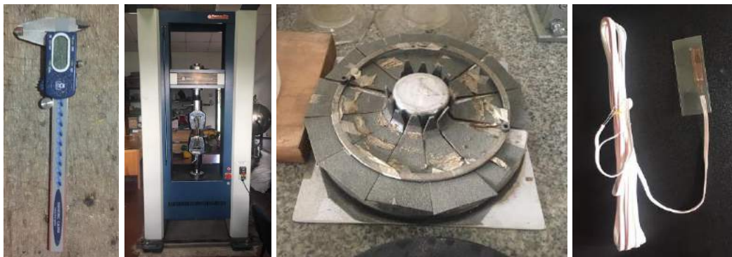
Figura 5-2 Instrumentos para el ensayo de compresión paralela. Fuente: autor.
