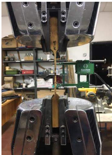
Figura 5-21 Montaje del ensayo de tensión paralela a las fibras. Fuente: autor.
